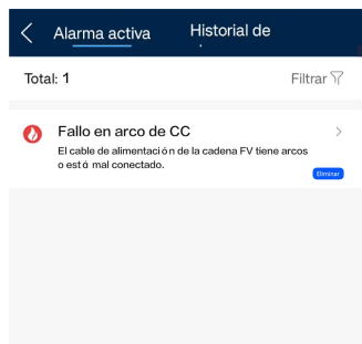
Figura 7-3 Eliminación de la alarma
